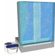
Als Frischbetonverbundabdichtung wird das Quellabdichtungsfliege mit der beschichteten Seite in Richtung der Sauberkeitsschicht ausgelegt (Bodenplatte) oder an der Schalung befestigt (Ortbetonwand). Die Bewehrung wird auf der unbeschichteten Seite des Vlieses verlegt, die beim Betonieren einen Teil des im Beton enthaltenen Wassers aufnimmt. Der Beton verkrallt sich regelrecht mit dem Abdichtungsvlies, so dass eine sichere und effektive Frischbetonverbundabdichtung entsteht.
