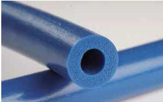
**WaterproofX<sup>®</sup> 1** wird eingesetzt zur Abdichtung von Arbeitsfugen zwischen zwei Betonierabschnitten. Dieser bauaufsichtlich geprüfte Injektionsschlauch weist nach allen Seiten in regelmäßigen Abständen Austrittsöffnungen auf, die dem Schlauch optimale Verpresseigenschaften verleihen. Die Wahl des Injektionsmaterials wird nicht
