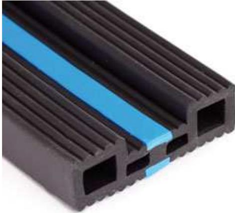
ist ein kombiniertes Kompressions- und Quellprofil zur Abdichtung von Betonfertigteiltugen. Die jeweils außen angeordneten Kompressionsdichtungen werden beidseitig beim Einbau komprimiert, wodurch sich eine Rückstellkraft auf die Fugenflanken entwickelt. Das mittig angeordnete, chemische Quellband fungiert als zusätzliche Abdichtung.
